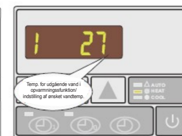
Opvarmningsfunktion Interval 15-40 °C
